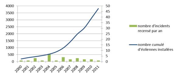
Les recensements effectués montrent que les incidents observés concernent principalement des modèles anciens ne bénéficiant généralement pas des dernières avancées technologiques (par exemple des pales en fibre de verre, plus résistantes, ou un système de freinage aérodynamique – qui équipent les éoliennes V100 et V110 du parc des Chênes).
